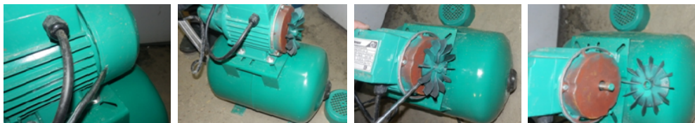
Рисунок 4. Снять вентилятор с помощью шлицевой отвертки.
