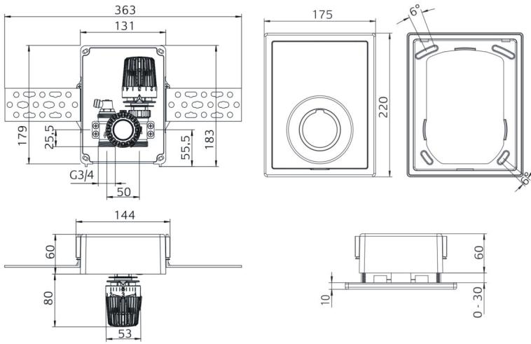
Глубина установки монтажного короба для блока составляет всего 60 мм.
