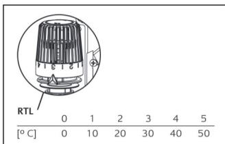
**TCB-K-RTL 01 – встраиваемый блок регулирования температуры воздуха в помещении.**
