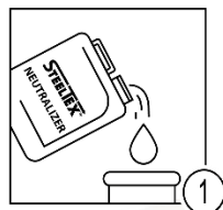
Шаг 1 - Приготовление промывочного раствора
