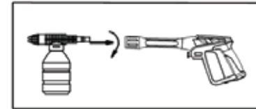
Рис. 8. Крепление устройства для подачи чистящего средства к пистолету
