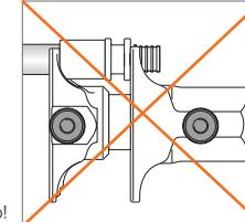
Перед вводом инструмента в эксплуатацию необходимо проверить правильно ли установлена расширительная насадка и хорошо ли она закреплена на запрессовочных тисках. (предотвращение выпадения расширительной насадки).
