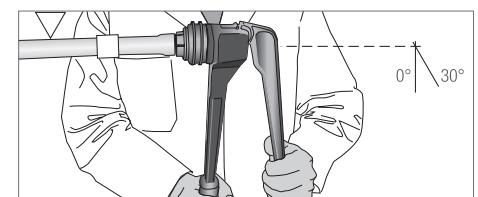
4. Вставьте штуцер фитинга в трубу до последнего ребра (до упора). Через некоторое время фитинг будеточно держаться в трубе (память формы).
