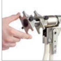
4. Замену запрессовочных насадок следует производить, когда инструмент находится в исходном положении (рукотки инструмента полностью разведены).
