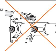
Не работайте с дефектной расширителем насадкой, иначе можно повредить трубу. Замену насадки
