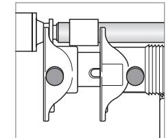
6. Переключить рычаг в верхнее положение для запрессовки соединения
