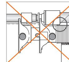
Регулярно смазывайте наконечник экспандера (тубик со смазкой прилагается). Не смазывайте наконечник слишком обильно, чтобы смазка не попала в трубу.
