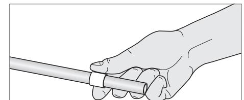
3. Расширение с помощью экспандера: Расширьте трубу один раз и повторите операцию повернув трубу на 30°. При этом обратите внимание на минимальное расстояние (одна длина надвижной гильзы) между расширителем насадкой и надвижной гильзой.
